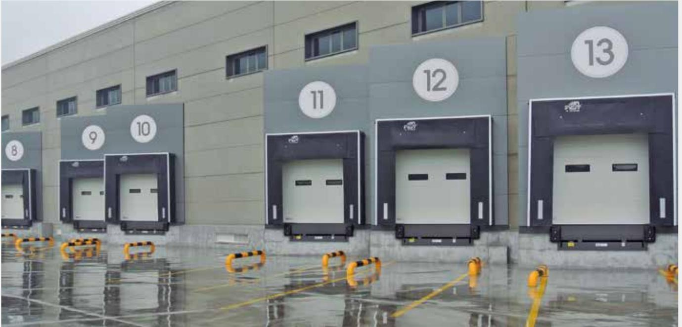
Puertas seccionales con mirillas en muelles de carga.
