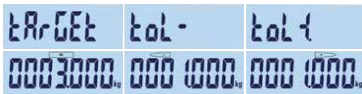
Figure 5-2 : affichage de la cible et des tolérances : cible (à gauche), tolérance basse (au centre), tolérance haute (à droite)
