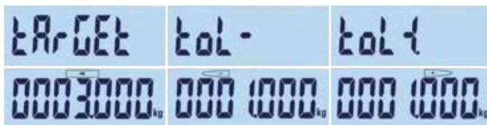
Figur 5-2. Mål og toleranse vises: Mål (venstre), lav (midten), høy (høyre)
