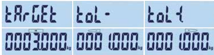
Abb. 5-2: Ziel- und Toleranzanzeigen: Ziel (links), unten (Mitte) hoch (rechts)
