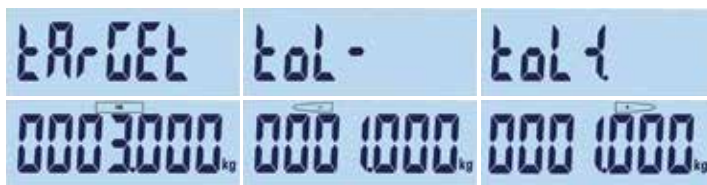
Figura 5-2: Pantallas de peso objetivo y tolerancias; objetivo (izquierda), tolerancia mínima (centro) y tolerancia máxima (derecha).
