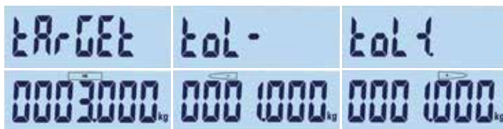
Figura 5-2. Target e visualizzazioni delle tolleranze: target (sinistra), bassa (centro) alta (destra)
