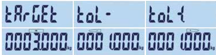
Figuur 5-2: Display van doel- en tolerantiewaarden: doelwaarde (links), ondergrens (midden), bovengrens (rechts)
