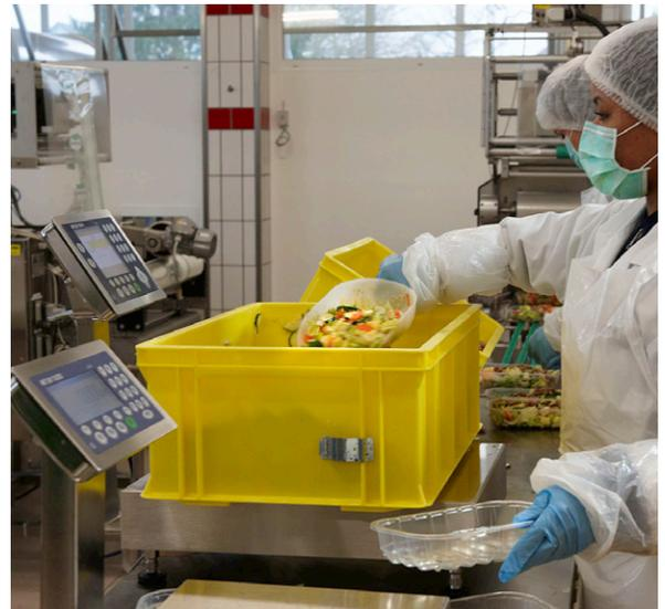
encuentra dentro del rango de tolerancia y, de ser así, restablecen la pantalla automáticamente. El operario llena la cantidad de porción en la cazoleta de porcionado y coge inmediatamente la siguiente porción.
