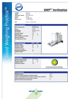
Figura 11: Ejemplo de un certificado de GWP® Verification y el contenido más relevante de este. El servicio GWP® Verification calibra su equipo de pesaje, evalúa los riesgos del proceso, recomienda medidas para mejorar la precisión del proceso y garantiza la conformidad con los requisitos normativos y del proceso. GWP® Verification se puede utilizar para cualquier dispositivo de pesaje, independientemente del modelo o el fabricante. Proporciona toda la información necesaria para mantener la precisión de las básculas y balanzas de por vida; se incluye la documentación para auditorías.
