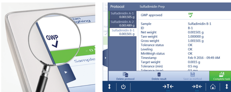
Figura 14: Funcionalidad GWP Approved de las balanzas XPR de METTLER TOLEDO. La etiqueta GWP ® Approved se muestra en la pantalla de la balanza de pesaje de una balanza XPR. Le proporciona la confianza, la trazabilidad y la prueba de que, en el momento de la medición, la balanza funcionaba de forma correcta, los límites de advertencia no se excedieron y el resultado es fiable.
