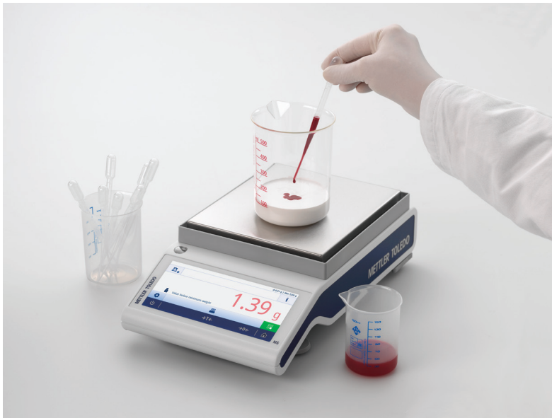
Figura 13: Permanencia dentro del rango de pesaje seguro. La función de advertencia preprogramada ayuda en los procesos de dosificación. En cuanto el peso supera el límite de advertencia, las cifras de la báscula cambian de rojo a negro para indicar que se cumplen las condiciones del rango de pesaje seguro.
